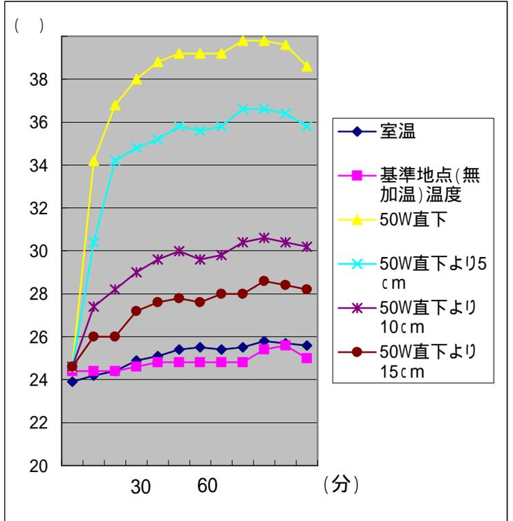
は平面(地面)から30cmの距離でネオハロゲン、電球を点灯させ、点灯開始30分後に照射面中央部の温度を計測したものです。
