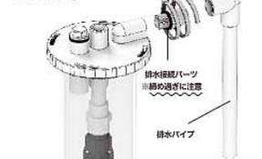
⑦ 給水口をリアクターハウジングキャップに接続します。この部分の接続がゆるいと、部品が抜けたり水漏れが発生する原因となりますのでご注意ください。給水口の向きを本体の設置場所にあわせて調節し、市販の塩ビパイプ用接着剤で必ず接着してください。
