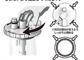
⑥ リアクターハウジングキャップに、排水接続パーツおよび排水パイプを接続します。排水接続パーツと排水パイプの接続部は、必要に応じて市販の塩ビパイプ用接着剤で接着してください。
