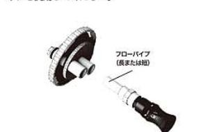
④ リアクターハウジングにリアクターハウジングキャップをのせます。この際、図のようにゴム製のOリング（パッキン）が装着されているか確認してください。
