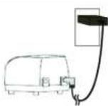
●ACアダプターの出力プラグを、本体のDC12ボルトジャックに差し込みます。(リキッドタイマー(アダプター付)の場合)
