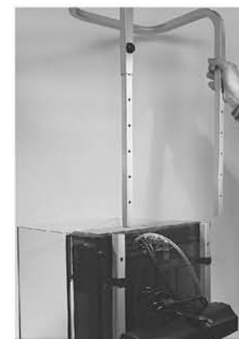
16.照明アームの取り付け
