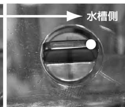
水流量調節バルブ上のポッチが水槽側 =水流量最小
