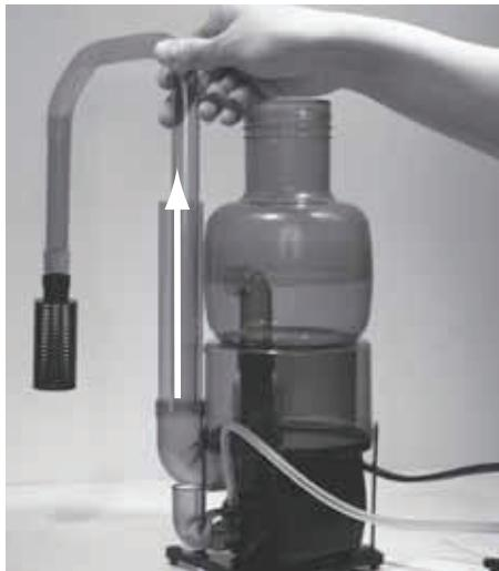
⑤ ゴミ受けカップをチャンバーに取り付け、ゴミ受けカップ固定ナットを軽く締め込みます。エアチューブをゴミ受けカップのチューブ挿し込み口に挿し込んで固定します。
