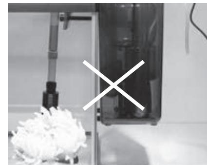
⑥ 本品を水槽縁に掛けた後、固定ねじを締めて固定します。固定ねじ用の穴は2つありますので、水槽に応じてご使用ください。
