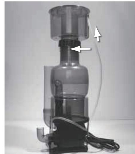
⑥ チャンバー部分をろ過槽内に設置します。強い水流の当らない安定した場所に設置してください。ろ過槽の水位は図の範囲に設定してください。水中に設置する際、チャンバー内が空の状態では浮力で自立できませんので、ゆっくりと水中に沈めるか、チャンバー内にカップなどで飼育水を直接汲みいれて呼び水を行い、チャンバー内に水が入るようにしてください。水位が下がりすぎると空回りによってポンプ故障の原因となります。水位が高い場合は、チャンバー内の水位も高くなりオーバースキミング(汚れが取れず、きれいな水が取れてしまう)が発生しますので注意してください。
