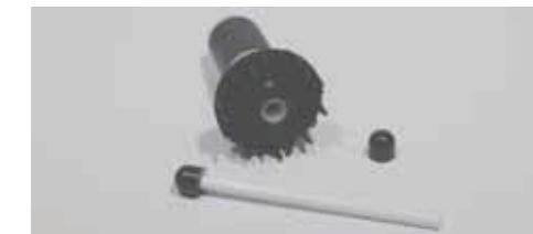
⑤ 必要に応じて、インペラ、シャフトを洗浄または交換し、図の方向にインペラを挿し込みます。シャフト両端についているゴムキャップを付け忘れないように注意しましょう。
